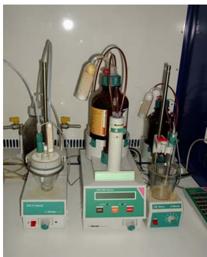
Obr. 2 Automatický potenciometrický titrátor 702 SM TITRINO na stanovenie celkového čísla kyslosti a obsahu vody
