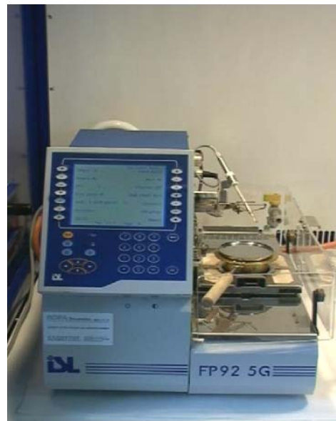
Obr. 3 Automat FP-92 5G na stanovenie bodu vzplanutia v otvorenom tégliku
