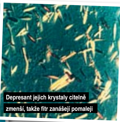
Krystaly parafinu vznikající v naftě jsou rozměrné a ucpávají filtry
